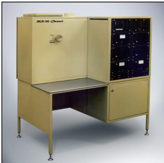
Люминесцентный сепаратор лабораторный ЛСЛ-20
